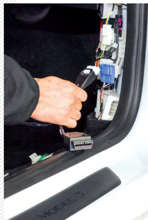
Über die originale Tesla-Diagnoseschnittstelle kommuniziert der mega macs direkt über den CAN-Bus mit den Fahrzeugsystemen s.o.
